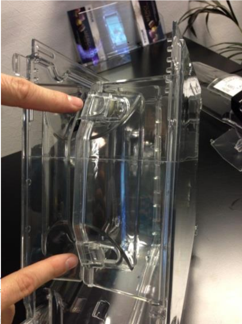
8 – déclipsez les deux parties latérales de la trémie
